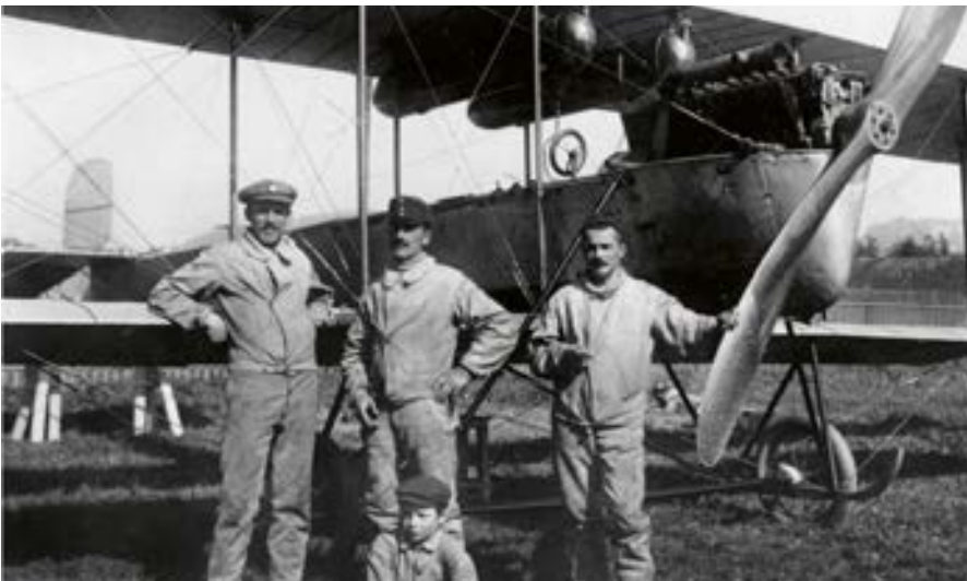
Die Astra CM 1914 nach dem Umbau im Berner Beundenfeld mit Radfahrwerk.
